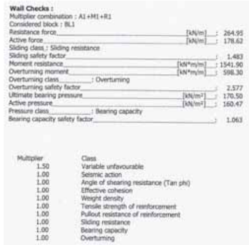
Fig. 3 Revisión de la estabilidad externa del muro
